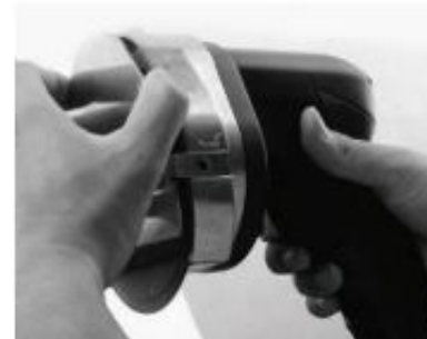
5. Monter la protection du couteau, la bague de réglage et la vis de blocage
