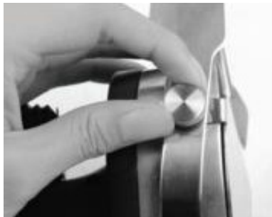
1. Dévisser la vis de blocage et la bague de réglage
