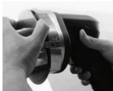
5. Installer la protection du couteau, la bague de réglage et la vis de blocage
