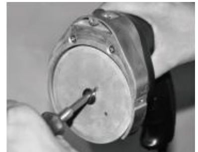
3. Dévisser la vis de fixation et retirer le couteau
