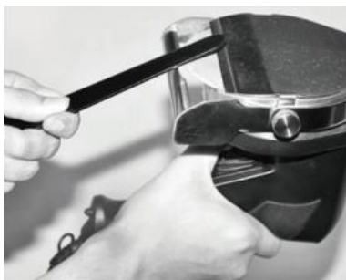
1. Aiguiser le couteau sans laisser de bavures, sous un angle très faible.
