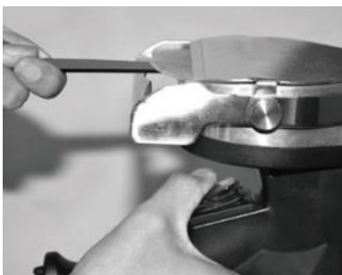
1. Aiguiser le couteau sans laisser de bavures, sous un angle très faible.
